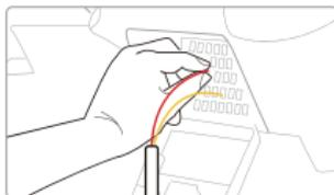
常時電源ケーブルを車両内部にあるヒューズボックスの端子に接続してください。
